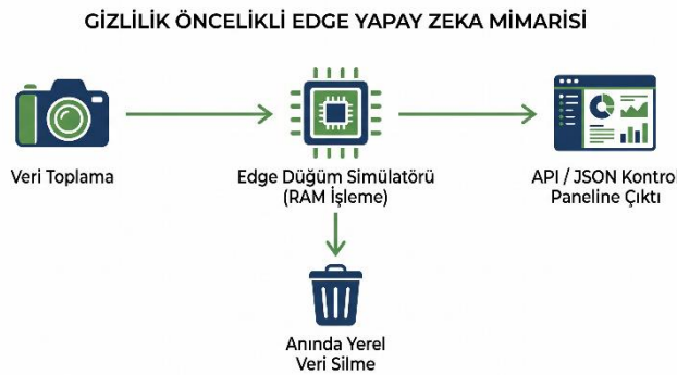
Şekil 1. Geliştirilen otonom sistemin uçta bilişim ve mahremiyet odaklı donanım mimarisi
