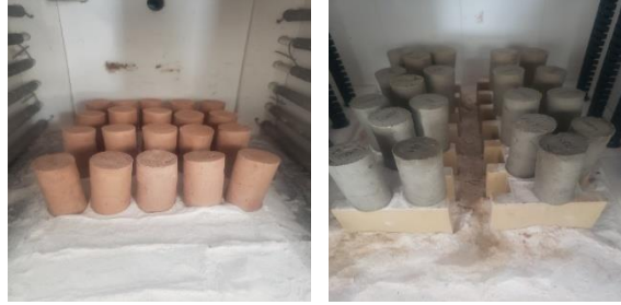
Şekil 3. Tuğla numunelerinin fırın içerisindeki dizilimi
