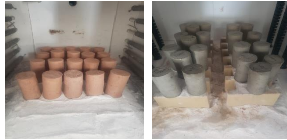
Şekil 3. Tuğla numunelerinin fırın içerisindeki dizilimi
