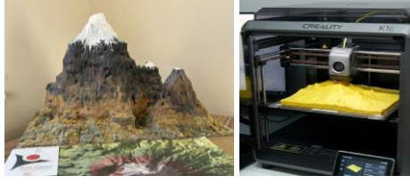
Şekil 1. Geleneksel Yöntemle Üretilen Maket ve 3B Baskı Modelinin Karşılaştırması
