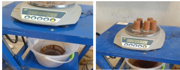
Şekil 4. Pişmiş numunelerin ağırlıklarının ölçülmesi
