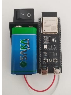
Şekil 1. ESP32-S3 tabanlı merkezi kontrol biriminin gerçek görüntüsü
