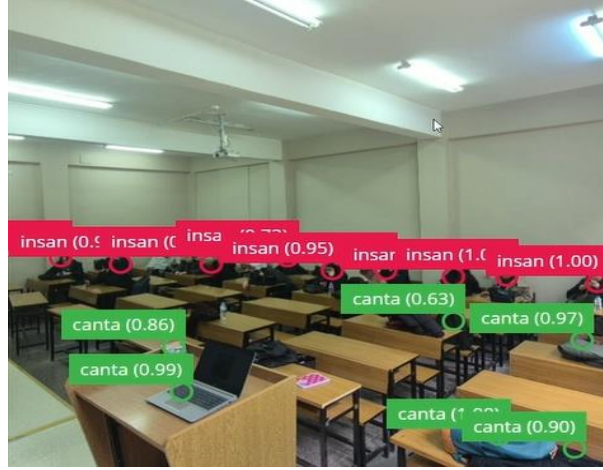
Şekil 2. Eğitilen FOMO modelinin merkez noktası (centroid) tabanlı tespit örneği
