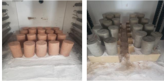
Şekil 3. Tuğla numunelerinin fırın içerisindeki dizilimi
