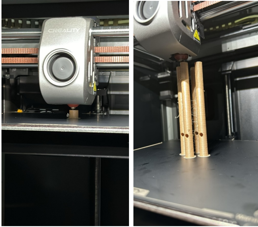
Şekil 4. Sipsi çalgı aletinin 3D baskı aletiyle basım aşaması
