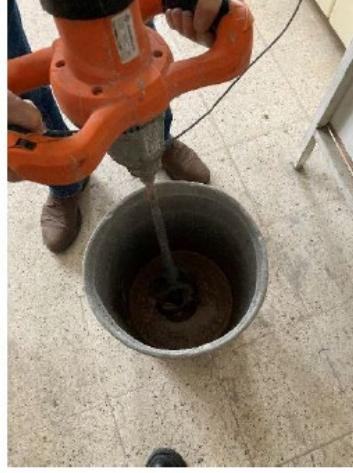
Alkali çözeltiye metakaolin ilavesi ile karıştırma işlemi başlamıştır.
