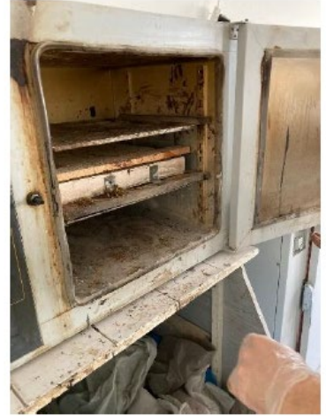
Etüvde 24 saat süreyle 65 °C sıcaklıkta kür edilmiştir.
