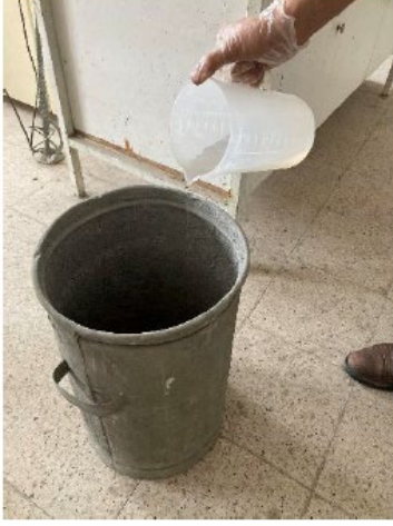
Hazırlanan alkali çözelti karıştırma haznesine konmuştur.
