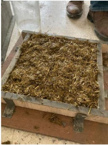
Karıştırma işlemi sonrası kalıplama işlemi başlamıştır.
