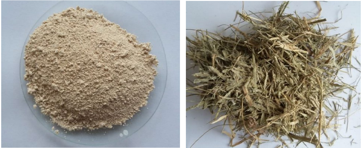
Şekil 1. Çalışmada kullanılan metakaolin ve lif kaynağı çimen
