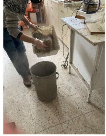
Atık çimen ilavesi ile karıştırma işlemi devam edilmiştir.
