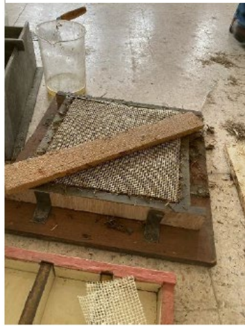
Yüzeyi düzeltilen numune sıva filesi ile örtülmüştür.
