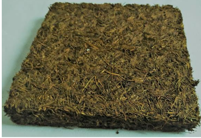
Şekil 3. Çimen lifinden geopolimer yöntemi ile üretilen yalıtım plakası (30x30x5 cm)
